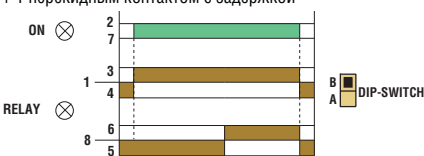
Задержка включения реле с 1 перекидным контактом + 1 перекидным контактом с задержкой
